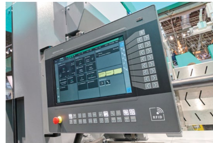
Az Allrounder Trend gépek az új, különösen könnyen kezelhető Gestic lite vezérlőrendszerrel vannak felszerelve, amely átlátható kezelőfelületet (dashboardot) kínál
