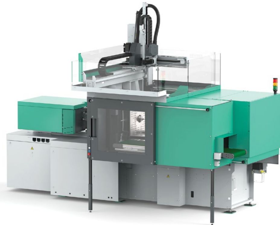
Az Allrounder Trend felszerelhető az Arburg robotrendszereivel és kompakt védőburkolataival az automatizált fröccsöntöttalkatrész-gyártás érdekében
