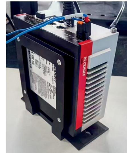
A CASNC Technology szerszámgépeinek igen hatékony magja a Beckhoff C6030 típusú ultrakompakt ipari PC. Fotó: © CASNC Technology
