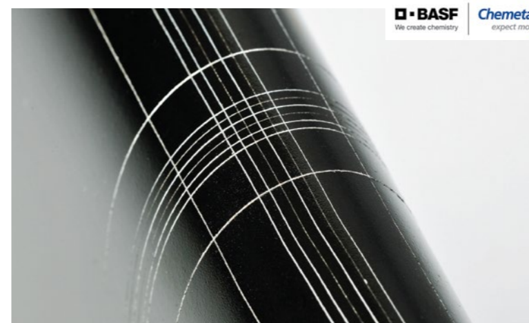
A VIANT kiváló tapadást biztosít GT0-val 504 és 1008 óra után
