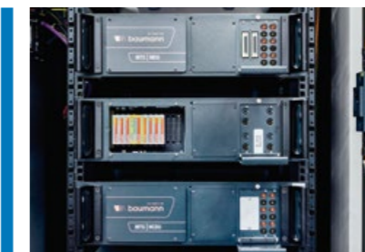
» Az MTS-rendszer mérés-technikai, nagyfeszültség-elosztó és erősáram-elosztó (rendre MDU-, HVDU- és HCDU-) egységei (levett fedőlap mellett látszanak az EJ-modulok)
