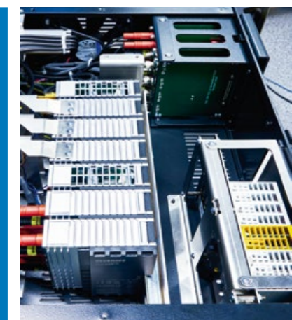
» Az EJ-modulokon (jobbra) és EL-sorozatú EtherCAT-terminálokon kívül az MTS-ben megtalálhatók a nagy pontosságú, ELM-sorozatú EtherCAT-mérőterminálok is (balra, itt az MDU-modulba van beépítve)
