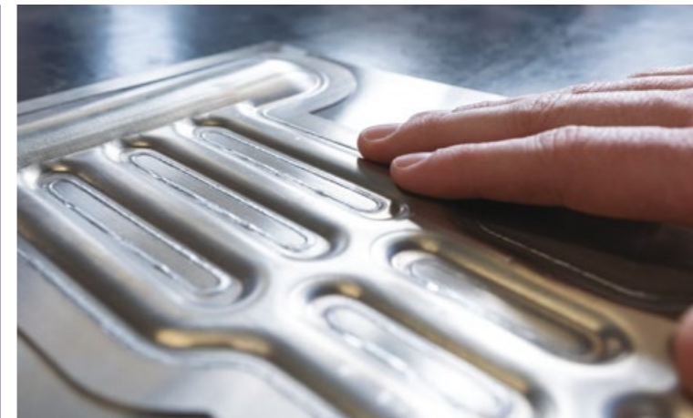
» A Trumpf technológiája alkalmas a rozsdamentesacél és alumínium hűtőlemezek nagy sebességű hegesztésére
