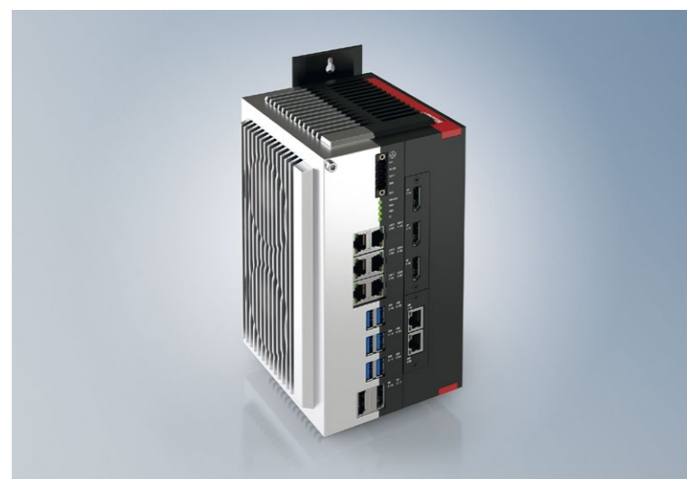
» Kis méretei ellenére a C6043 ultrakompakt ipari PC elegendő helyet kínál a külső grafikus kártya gyári beépítéséhez
