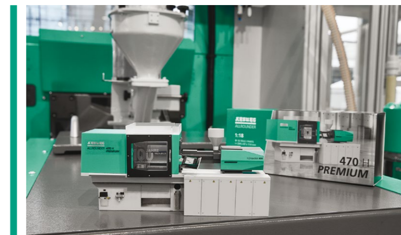
» A Fakuma 2023 rendezvényen egy Allrounder 520 H „Premium” 1+1+1 fészkes szerszám-családdal gyártott gépvázat, granulátumtárolót és vezérlést. A három komponens egy 1:18 méretarányú Allrounder modellhez
