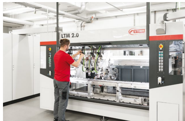
» A kompakt automatizálási rendszerként működő gép alapja egy mereven összekapcsolt szállítási rendszer, amelynek egyebéi az ügyfél igényeitől és specifikációitól függenek
