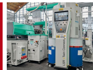
» A hozzá tartozó Reinhardt Technik LSR-adagolórendszer OPC UA és Euromap 82.3 interfészen keresztül lett integrálva a Gestica vezérlésbe
