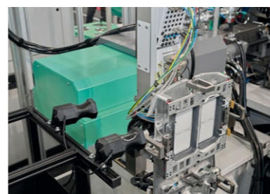
» Az alkalmazás magas követelményeket támasztott a függőlegesen mozgó Multilift V 30 robotrendszerrel szemben, amely eltávolította a 164 darab 2K dobozt a szerszámából, majd azokat egy szállítószalagra helyezte
