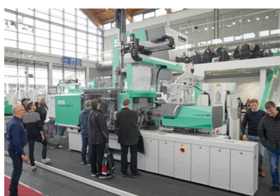
» Nagyobb modularitás, több hely és könnyebb kezelhetőség mellett: a Fakuma 2023 kiállításon egy Allrounder More bemutatta az energiahatékony kétkomponensű fröccsöntés lehetőségeit
