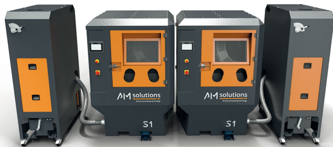
» Az S1 lehetővé teszi az összetett formájú, kényes alkatrészek utófeldolgozását egyetlen szóróanyaggal, egyetlen folyamat során – teljesen konzisztens eredményekkel és nagyon rövid ciklusidővel. Fotók: Rösler Oberflächentechnik GmbH
