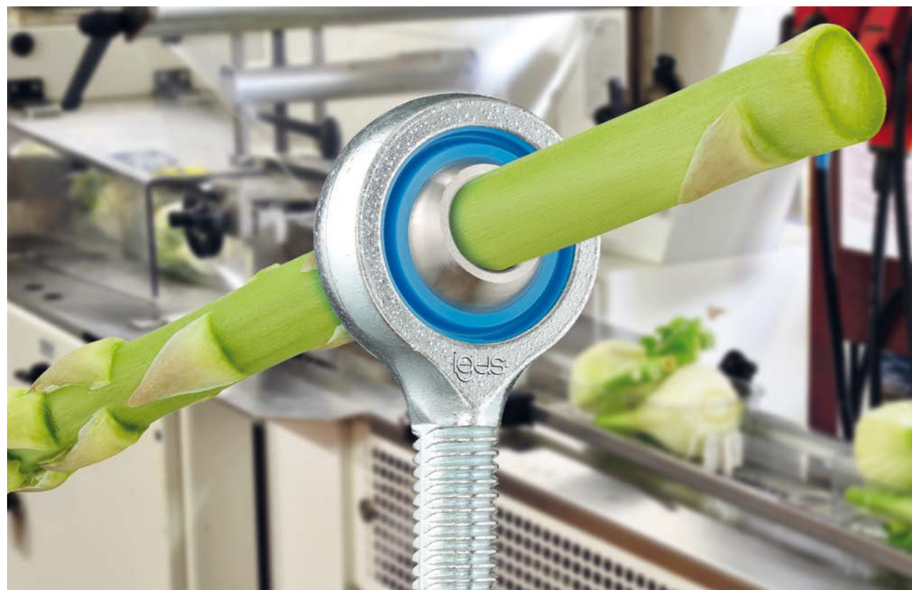
» Kenésmentes és karbantartást nem igénylő igubal gömbcsukló nagyobb terheléssel járó élelmiszeripari alkalmazásokhoz, rozsdamentesacél házból és csapágygolyóból, valamint nagy teljesítményű iglidur A160 műanyagból készült belső gyűrűből áll, amely megfelel az FDA és az EU 10/2011 követelményeinek (forrás: igus GmbH)
