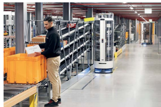
Az automatikusan irányított járművek hajtástechnológiájának fontos eleme, hogy a kefe nélküli egyenáramú szervomotorok alkalmasak a kerekek meghajtására
