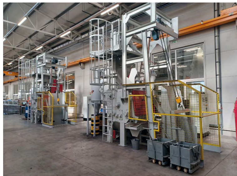
» A cinklamellás bevonatozótechnológia segítségével vékony korróziógátló bevonatot lehet felvinni a kis méretű, tömeggyártott alkatrészek felületére
