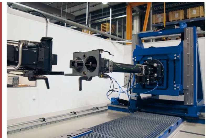
» A központi vonó- és ütközőkészülék mechanikus, pneumatikus és elektronikus kapcsolatot hozhat létre a szerelvények között
