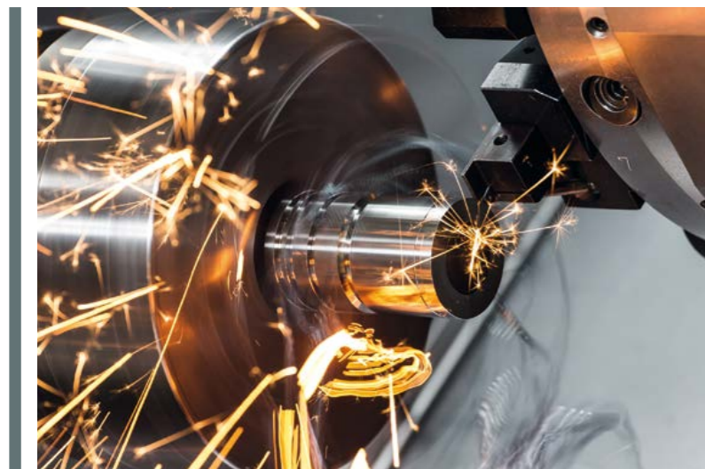
» Kemény acélok esztergálásakor és beszuró marásakor a Horn a CBN szerszámnyagra hagyatkozik. Forrás: HORN/Sauerermann
