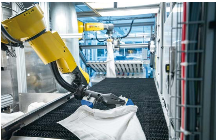
» Az ipari mosodákban az automatizálásnak köszönhetően akár napi 100 tonna textília feldolgozása is megoldható emberi beavatkozás nélkül
