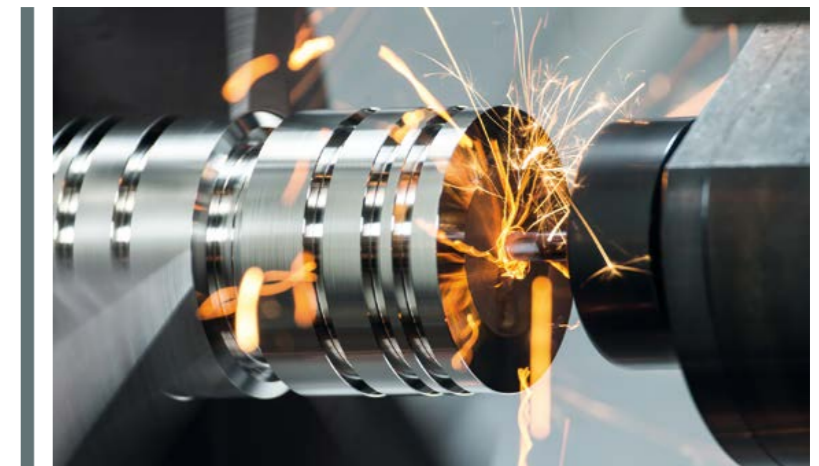
» Kemény acélok megmunkálásakor a speciális bevonattal ellátott tömör keményfém szerszámok nagy teljesítményt nyújtanak. Forrás: HORN/Sauerermann
