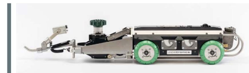
» A csatornázások során a szabványos megoldások ritkán alkalmazhatók. Nagy teljesítményű robotokra van kis méretben szükség
