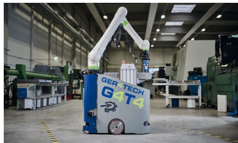
» A G4T4 az első autonóm mobil robot (AMR), amely kifejezetten a gyártáshoz tervezett hattengelyes robot
