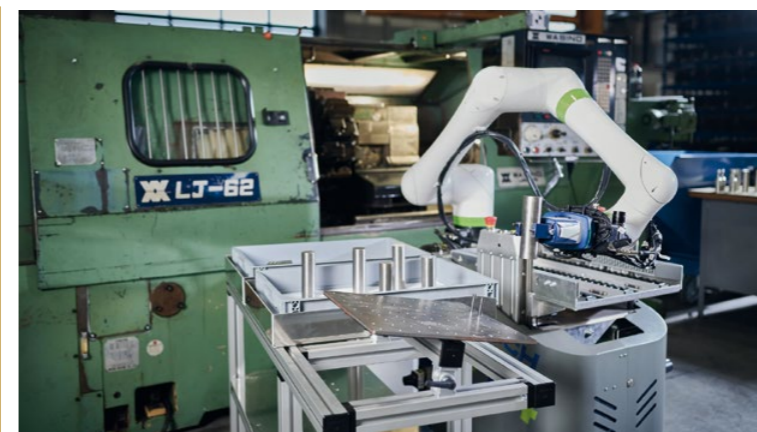
» A G4T4-et a Schunk Co-act EGP-C elektromos kollaboratív megfogója, Sick biztonsági szkennerek és egy Siemens biztonsági PLC egészíti ki. A struktúrát a FANUC iRVision kamerarendszere teszi teljessé
