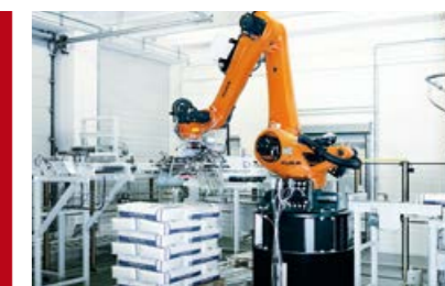
» A raklaprakodó robotok 40 és 700 kilogramm közötti súlyokkal könnyedén elbánnak
