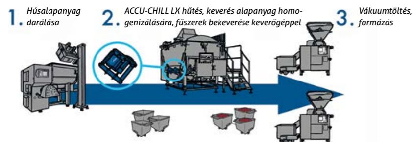
» Formázott húskészítmények gyártási folyamata az ACCU CHILL® LX alkalmazásával
