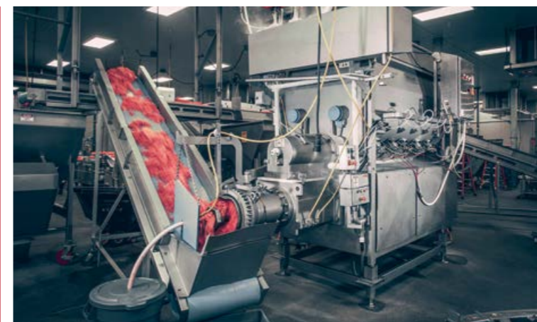
» Darálthús alapanyag szabályozott hűtése az ACCU CHILL® LX alkalmazásával
