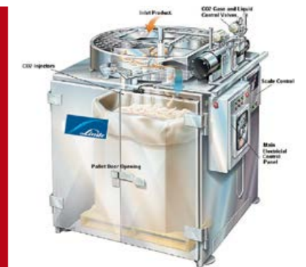
» Linde ACCU-CHILL Combo Chiller működési elve
