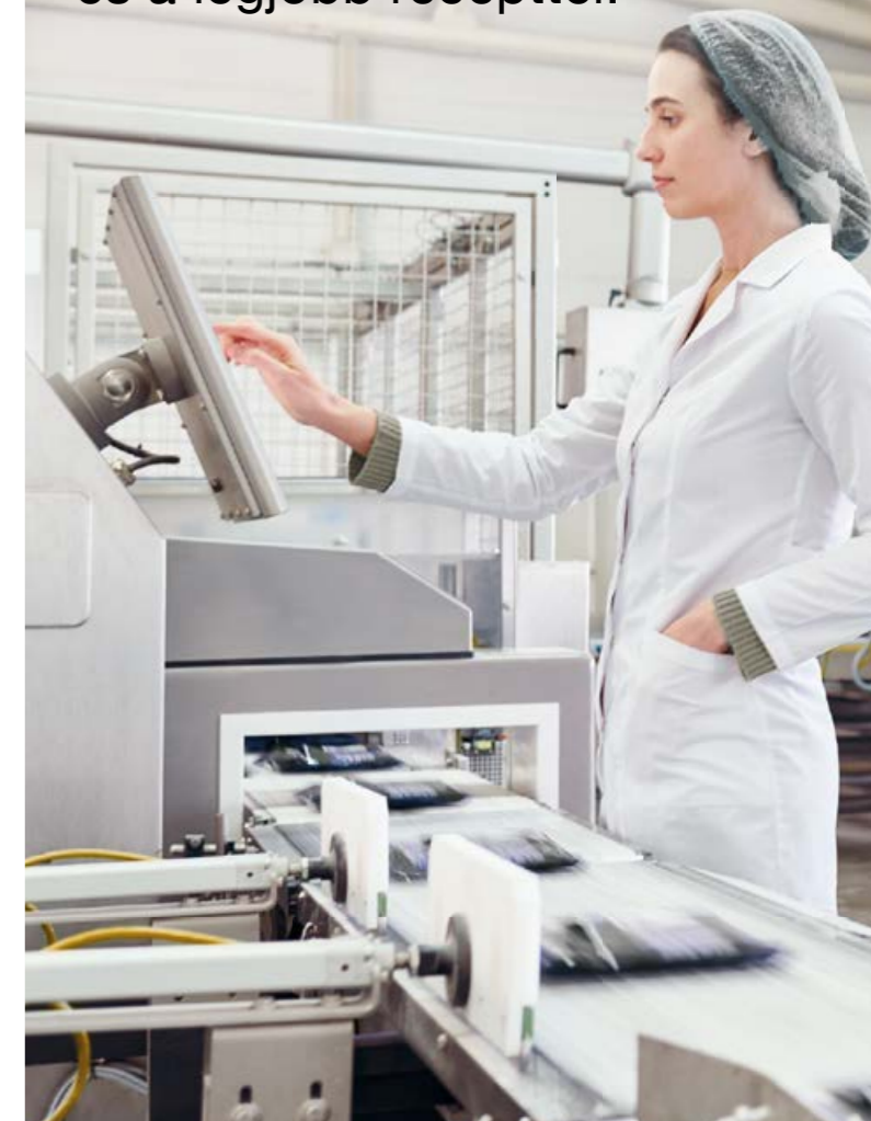
» A Klüber Lubrication LubeRight digitális kézi kenési rendszere azonosítja az egyes kenési pontokat, megjeleníti a megfelelő kenőanyagot és a kiadagolandó zsír mennyiségét
