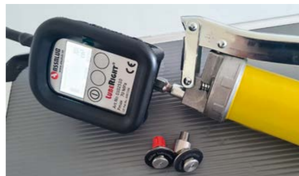
» A Klüber Lubrication LubeRight digitális kézi kenési rendszere azonosítja az egyes kenési pontokat, megjeleníti a megfelelő kenőanyagot és a kiadagolandó zsír mennyiségét
