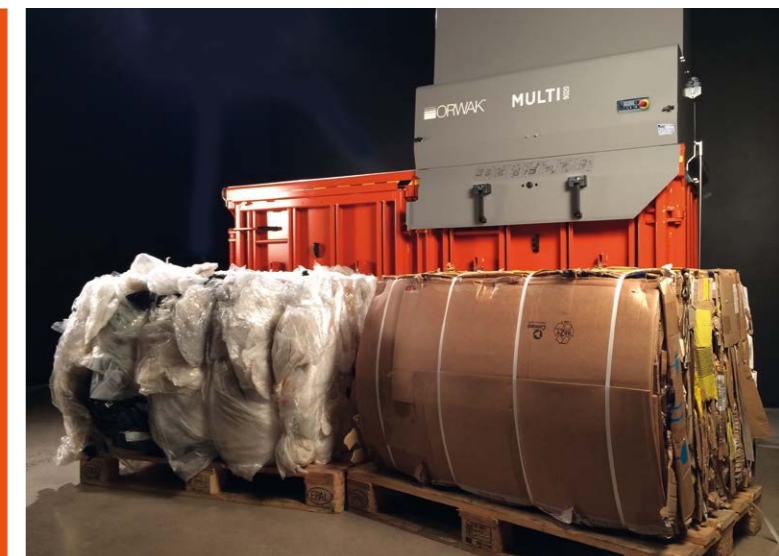
» Az újrahasznosítható csomagolóanyagokból bálázógép használatával nagy sűrűségű, ideális méretű és súlyú bálák készíthetők
