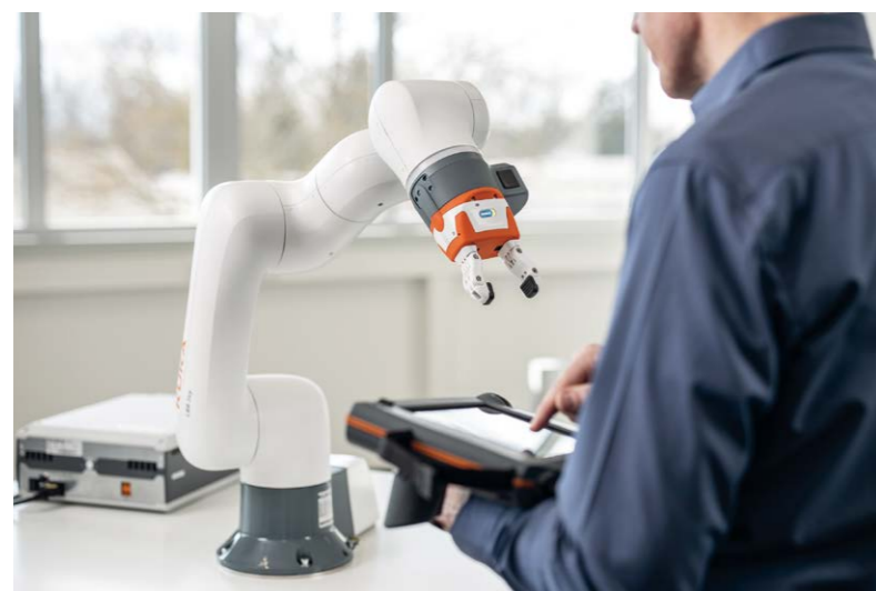
» A LBR iisy 11 és LBR iisy 15 hasznos teherbírása 11, illetve 15 kg, a hatótávolsága 1, 300, valamint 930 mm
