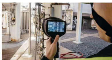
» A 124 mikrofonos kamera képes a 16,5 kHz-es és a 18,5 kHz-es kicsi szivárgást is érzékelni és lokalizálni
