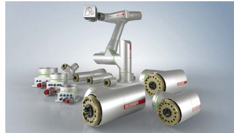
» Az ATRO-rendszer elemeiből bármilyen felépítésű robot összeállítható
