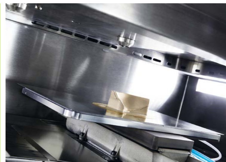
» Egy magas hőmérsékleten működő Freeformer képes orvosi jóváhagyott eredeti PEEK-et, például az Evonik „Vestakeep® i4 G”-t, egyedi koponyaimplantátumokká feldolgozni, beleértve a támasztóanyagot is
