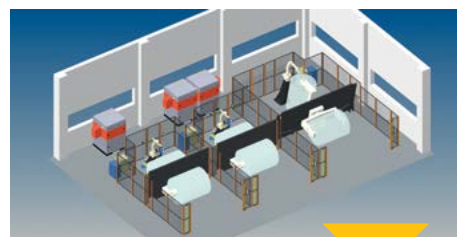
Három robotcella elrendezési modellje
