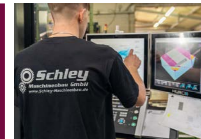
» Programozás kérdése: a kezelő napközben egyedi alkatrészeket gyárthat, majd a gép a műszak végeztével önállóan képes szériagyártásra
