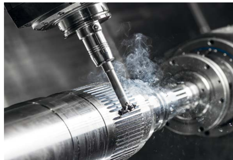
» A Horn marórendszere vibrációmentes megmunkálást biztosít még hosszú túlnyúlás mellett is
