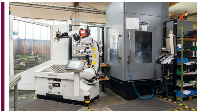
» A Schley Maschinenbau cégnél egy öttengelyes VC 500 i feltöltését egy Robojob Mill-Assist végzi
