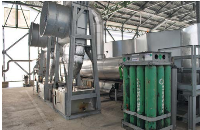
// Több fázisban hőt adva a rendszerhez létrejön a szénhidrogénolaj, gáz és némi szénpor végtermék (Fotó: Almási Imre)
