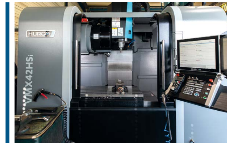
» Házon belüli szerszámgyártás kialakítása az Austria Druckgussnál: tavaly óta a HURCO 3 tengelyes gépe végzi a munka oroslánrészét
