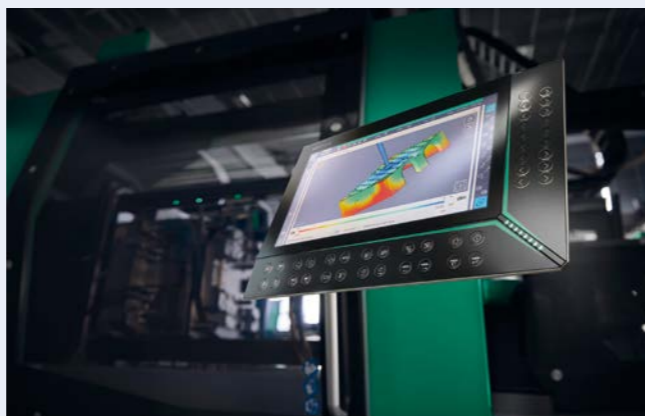
Az Arburg összes hardver- és szoftverfejlesztési tapasztalatát belefoglalták a GESTICA vezérlésbe. Az integrált „aXw Control FillAssist” segítő funkciónak köszönhetően az ALLROUNDER úgymond ismeri azt a fröccsdarabot, amelyet gyártania kell
