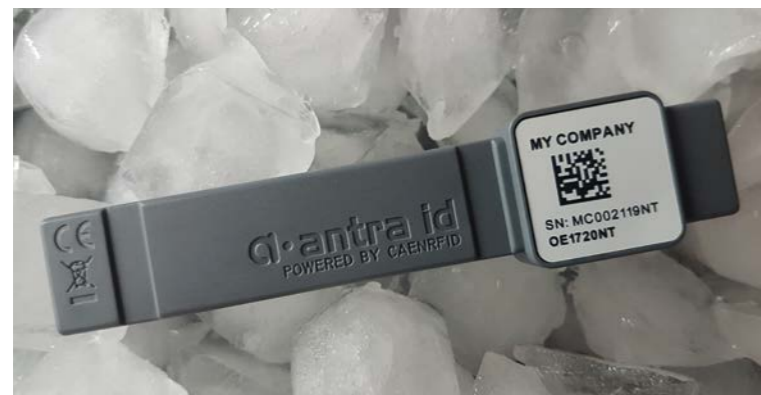
» A különleges körülményeket igénylő áruk dobozát az Antra ID szemi-passzív RFID-tagekkel látja el, ami előre beprogramozott időközönként monitorozza a termék körülményeit
