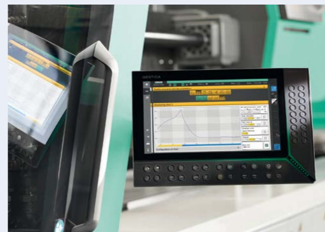
A GESTICA vezérlés különféle asszisztensrendszerei támogatják az alkatrészek gyártását a folyamat kezdetétől a stabil folyamatig. Az újrahasonított anyagok feldolgozásakor pl. az „aXw Control PressurePilot” a forma folyamatos kitöltéséről gondoskodik
