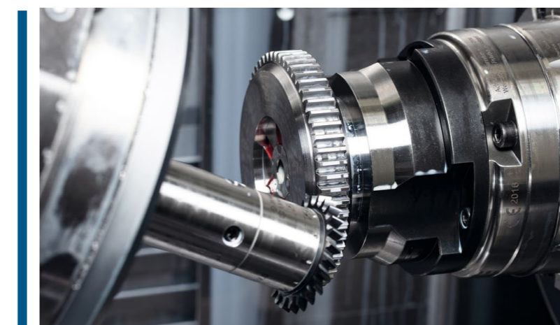
» A skivingtechnológiának köszönhetően a fogaskerekek megmunkálása húsz percről hétre csökken. Forrás: HORN/Sauerermann
