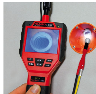
» Runpocam RC2 cső vizsgálat Ø 20 mm átmérő fölött
