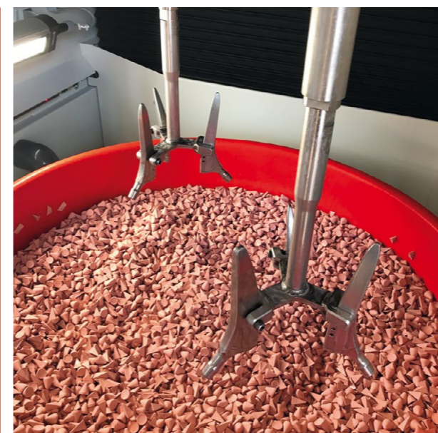
» A protézisek egy speciálisan erre a célra tervezett befogóhoz vannak rögzítve, amely univerzálisan használható minden csípőszártípushoz és -mérethez. Az első fázisban – nedves csiszolás és előpolírozás – egy speciális keverékkel kombinált műanyag közeg keverékét használják
