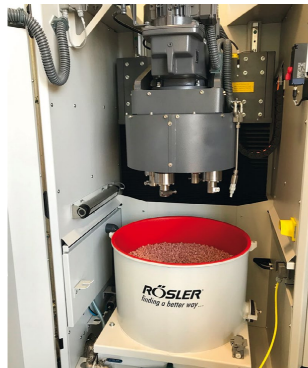
» Az MBN Präzisionstechnik a csípőszárak felületi megmunkálásához a kézi csiszolást és az azt követő elektropolírozást egy kétlépcsős, teljesen automatikus eljárással váltotta fel (Fotók: MBN Präzisionstechnik GmbH)
