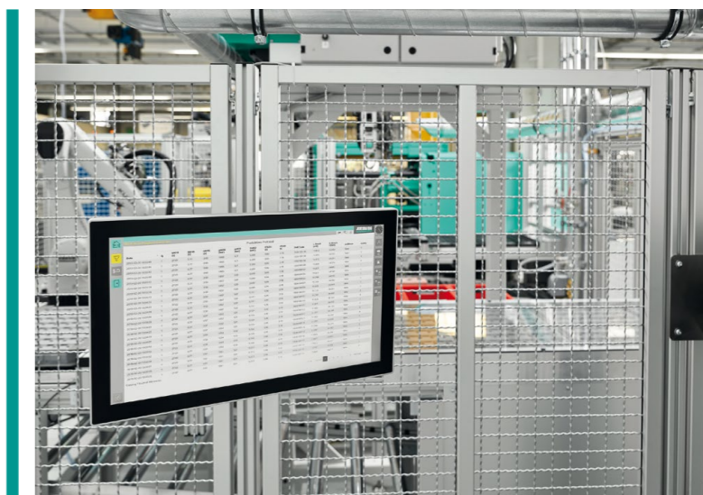
» Az ATCM megjeleníti a teljes rendszert, illetve rögzíti a folyamat- és a tesztadatokat
