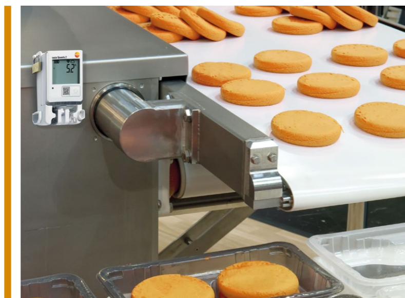
» A testo Saveris 2 adatgyűjtő a gyártósor környezeti hőmérsékletének mérése közben
