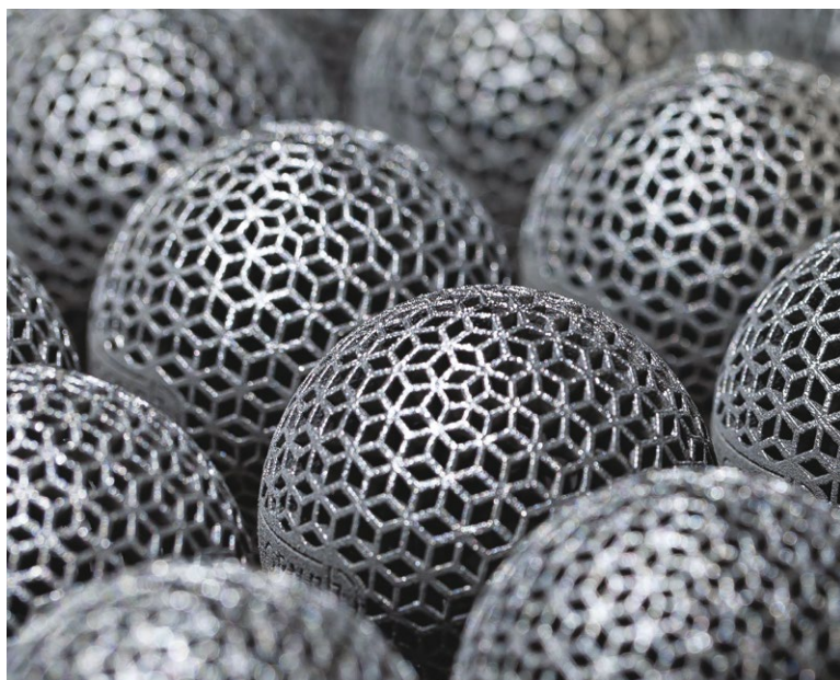
» A lézer rétegről rétegre építi fel az alkatrészeket
