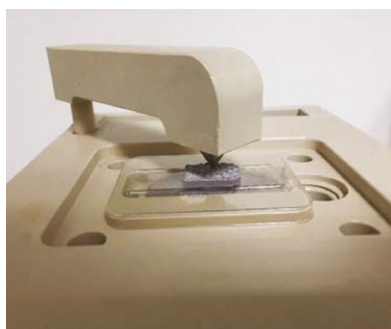
» Minta előkészítése elektrolitos polírozással
