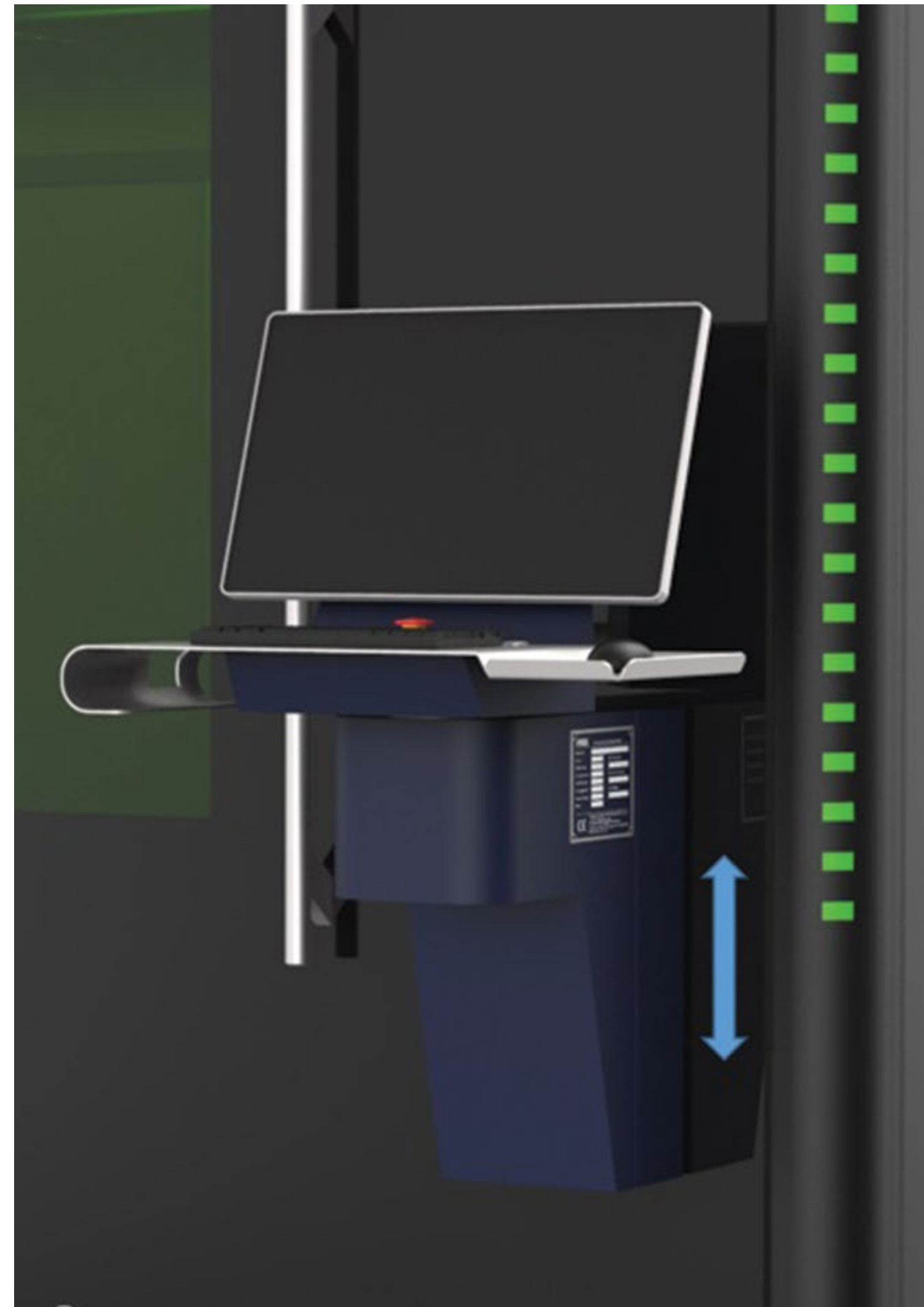
» Az új Xlase G3015T fiberlézervágó emelhető kézipanelje
