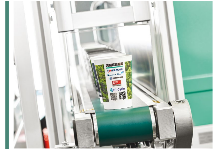
» Az automatikus gyártási folyamat minden poharat dekorál és ellát két DM-kóddal
