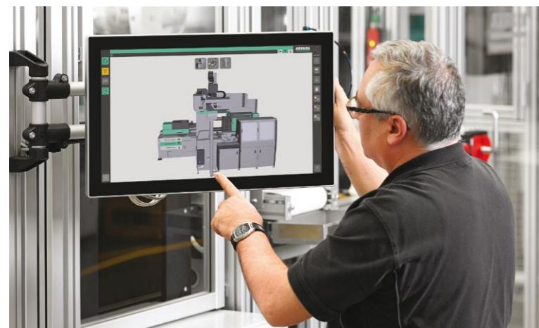
» Az Arburg Turnkey Control Module (ATCM) Scada rendszer az ivópoharak teljesen automatikus gyártása közben megjeleníti az összes lényeges gyártási és minőségadatokat
