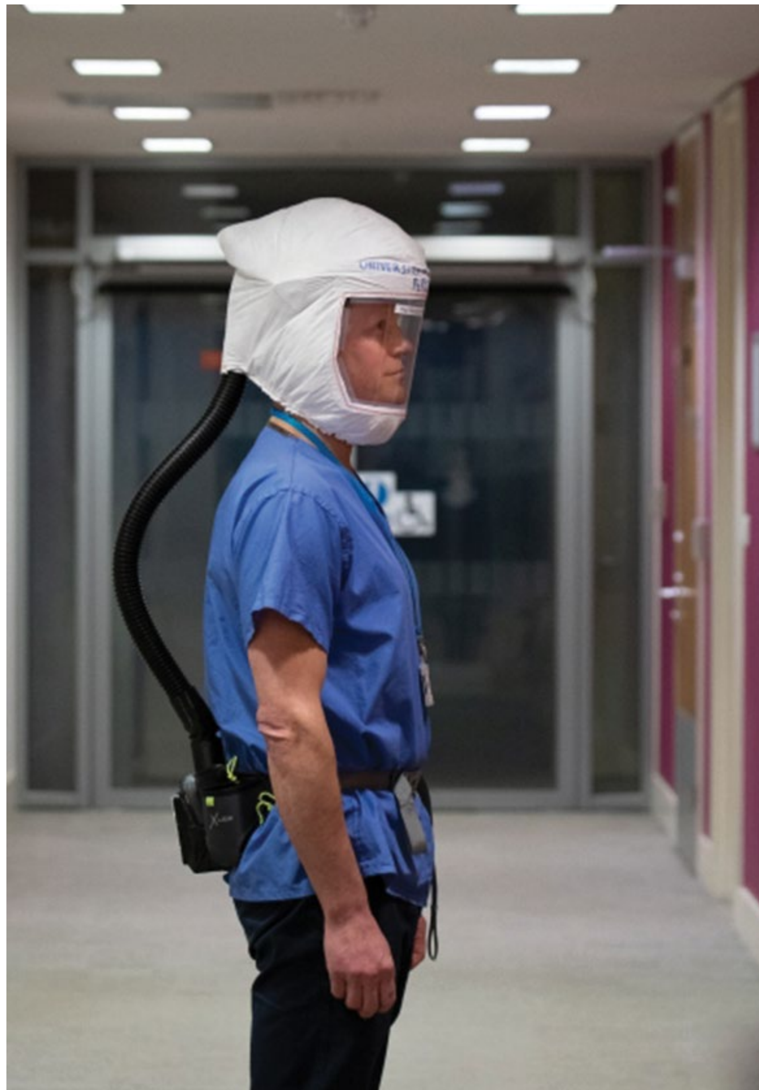
// A Southamptoni Egyetem tudósai által fejlesztett hordozható légzőkészülék
